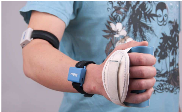
Rehabilitacijski sistem BiMeo (Kinestica d. o. o., Ljubljana, slika uporabljena z dovoljenjem) sledi bolnikovim gibom s pomočjo senzorjev pospeška, pritrjenih na roko.
